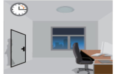
Armaturen släcks automatiskt efter hålltiden när ingen rörelse detekte-
