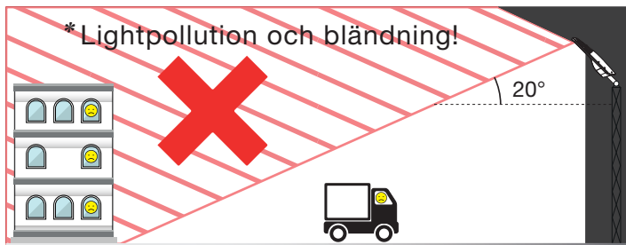
Armatyr montage \geq 10^\circ i förhållande till marken. Lightpollution och bländning
