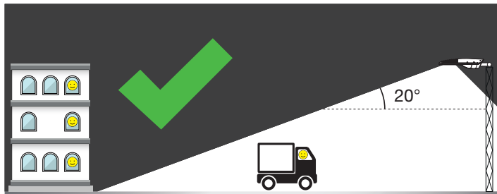
Armatyr montage 0° i förhållande till marken. Ingen lightpollution och bländning
