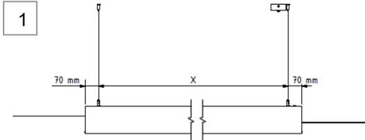
1. Abstand X = ist gleich der Bohrungsabstand für die Seilabhängung !
