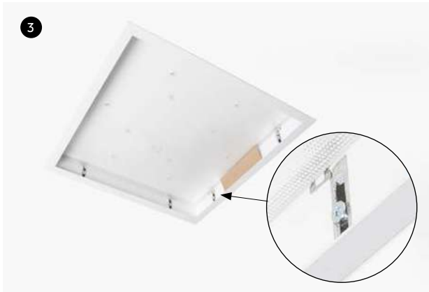
3 Schrauben an den Deckenrand senken, bis zum zweiten Gewinde einschieben und festschrauben Lower the screws to the edge of the ceiling, insert them up to the second thread and screw them tight
